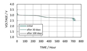
Charging Condition : CV(3.4V, 160 $\Omega$ , 48H, 60°C) Discharging Condition : CR(30k $\Omega$ , 60°C)
