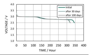
Charging Condition :  $CV(3.4V, 560\Omega, 48H, 60^{\circ}C)$ Discharging Condition :  $CR(100k\Omega, 60^{\circ}C)$
